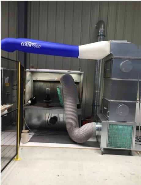
Absaugung von Farbnebel eines Lackiertisches
